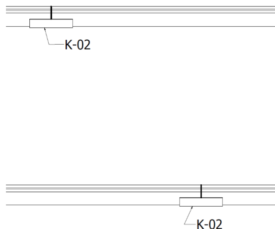
RYS. 10 Poprawny montaż łączników K-02
